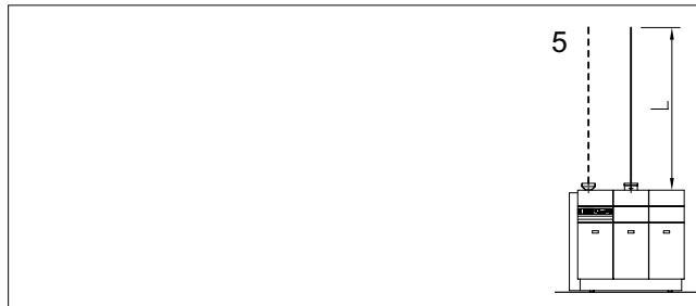
Fig. 06 Uitvoering luchttoevoer en rookgasafvoer
